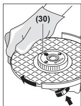
按压主轴锁定键(2)来固定研磨主轴。固定快速夹紧螺母时，请顺时针用力旋转砂轮片。
