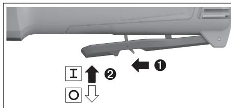
如要运行电动工具，请将解锁杆(29)向前推，然后向上按压起停开关(28)。
