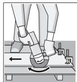
必须逆着机器的转向推动电动工具，否则容易失控，导致电动工具从切线中滑出。切割型材和方管时最好使用最小的截面。
