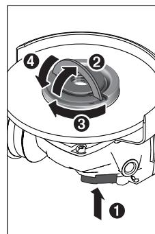
按压主轴锁定键(2)来固定研磨主轴。固定快速夹紧螺母(15)时，请向上翻起快速夹紧螺母的夹箍并顺时针用力旋转快速夹紧螺母。然后翻下夹箍以便固定快速夹紧螺母。仅拧紧砂轮/切割片边缘是不够的。
