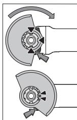
将防护罩(7)放到电动工具的支座上，直至防护罩的编码凸轮与支座重合。按压并按住解锁杆(1)。将防护罩(7)压到主轴颈上，直至防护罩的凸肩套在电动工具的法兰上，然后转动防护罩，直至能够清楚地听见卡止声。根据工作需要调整好防护罩(7)的位置。为此朝上推动解锁杆(1)，然后将防护罩(7)转到所需位置。
