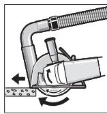
接通电动工具，并把引导滑座的前部放在工件上。参考工件的物料，适当地施力推进机器。
