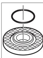
在固定法兰(9)的定心凸缘上套有一个塑料件(O形环)。如果O形环缺失或损坏，在继续使用磨机前必须更换固定法兰(9)。
