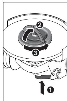
如果安装正确而且快速夹紧螺母(15)未损坏，就可以用手松开快速夹紧螺母。请向上翻起快速夹紧螺母的夹箍并逆时针用力旋转快速夹紧螺母。对于卡住的快速夹紧螺母，切勿使用工具，而是要用双销扳手松开。
