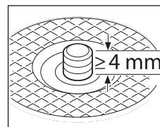
安装完固定法兰和砂轮或切割片之后的自由研磨主轴螺纹长度必须至少为4毫米。
